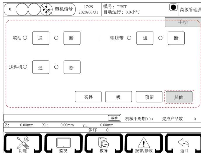
点击喷油按钮“通”即喷油输出点通，点击按钮“断”即喷油输出点断开动作。
