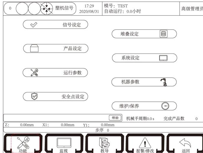
功能设定页面包含“信号设定”、“产品设定”、“运行参数”、“安全点设定”、“堆叠设定”、“系统设定”、“机器参数”和“维护/保养”等八个子页面。
