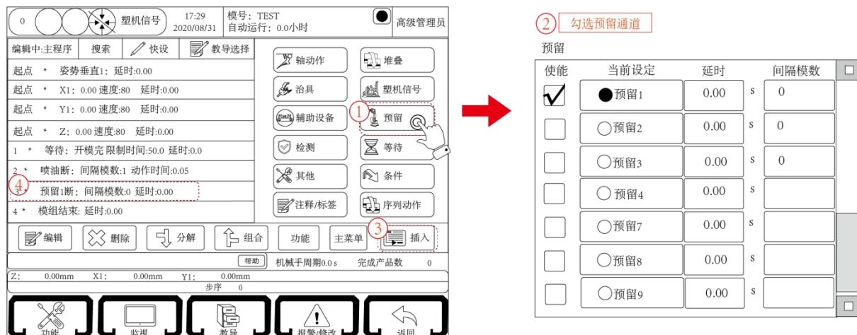
本系统设置 8 组预留输出点，若程序中教导预留动作，自动运行时，运行到预留通动作后，预留点开始输出，运行到预留断动作后，预留点断开输出。
