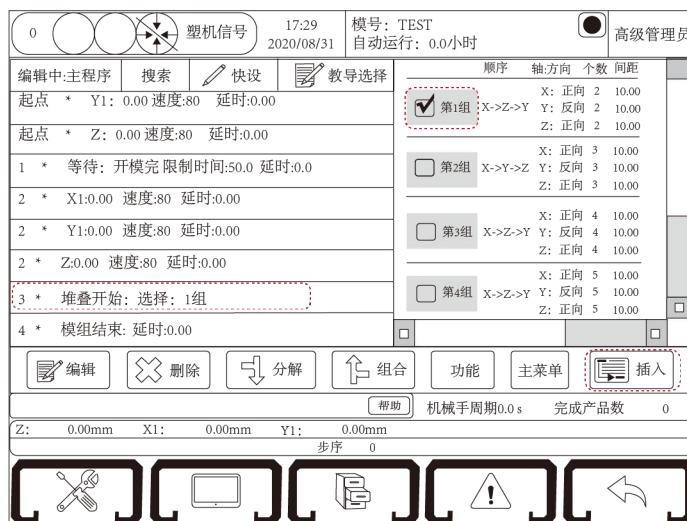
选中要插入的堆叠程序左边的方框, 如选择第 1 组堆叠程序, 再点击“插入”按钮将该组堆叠程序插入到要开始堆叠的程序步前, 自动运行时, 机械手即按照此堆叠程序堆叠排放产品。如果要使用 Y 轴进行堆叠时, 务必将堆叠程序插入到 Y 轴下降动作的前一步。
