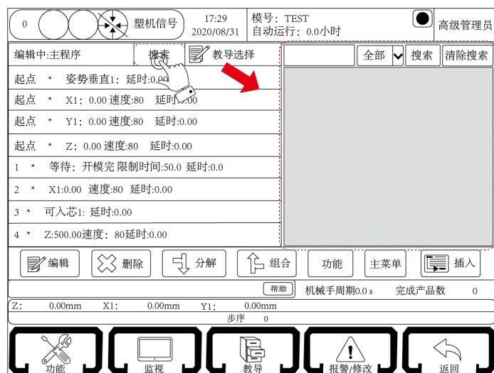
2) 在左侧输入框中输入所要查找的关键字，如要查看与 1 有关的所有动作，可直接输入“1”，然后选择搜索范围如全部，再点击“搜索”按钮即可出现与 1 相关的所有动作，如下显示：
