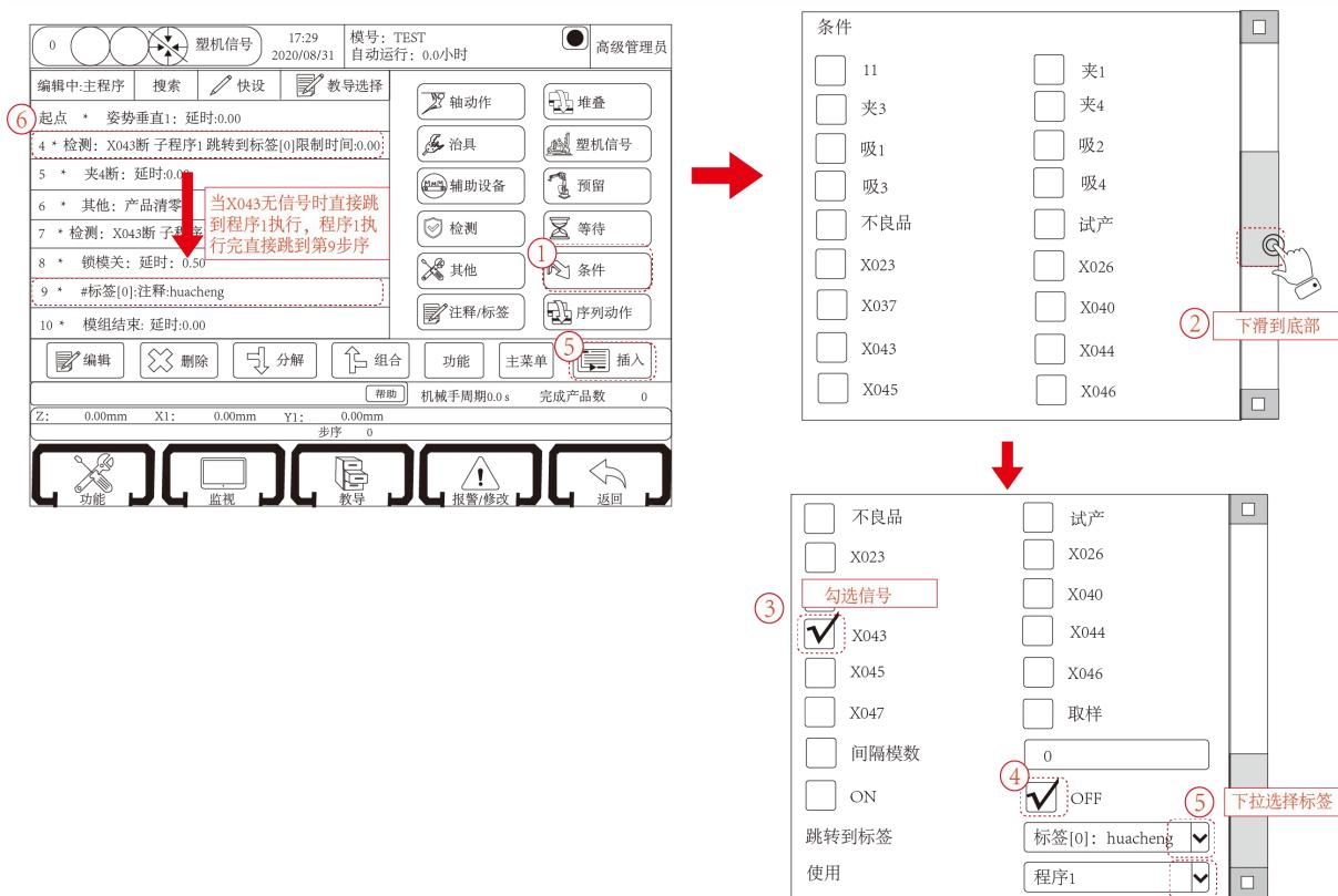
上图以信号的通断作为判断条件的案例，点击“条件”按钮可进入条件的教导页面，选择信号“X43”并勾选限制条件“OFF”作为判断条件，将条件插入主程序相应位置，当程序执行到该序号时，如果没有检测到信号就进入子程序执行该子程序内的动作，完成后再跳转回主程序的注释标签处，如果检测到有信号则继续执行主程序的动作而不会跳转。
