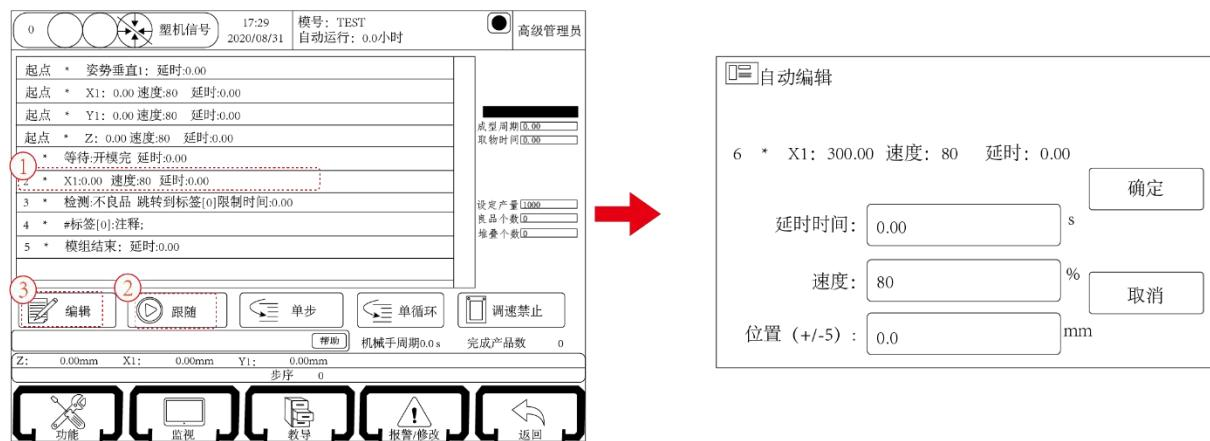
在该对话框可修改该动作的延时时间、电动轴的速度和位置，更改参数后再点击“确定”键，参数会被在线接受，从下个循环开始会按更改后的参数运行，若要取消该动作可按“取消”键。
