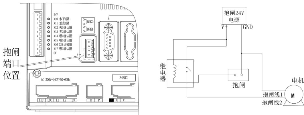
\*注：抱闸端口必须通过外接继电器去控制抱闸器工作
