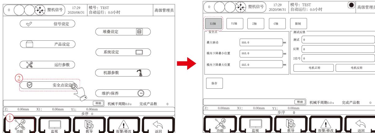
**电机反转：**默认电机逆时针旋转时，轴向离开原点方向移动；若勾选电机反转，则电机逆时针旋转时，向靠近原点方向移动。
