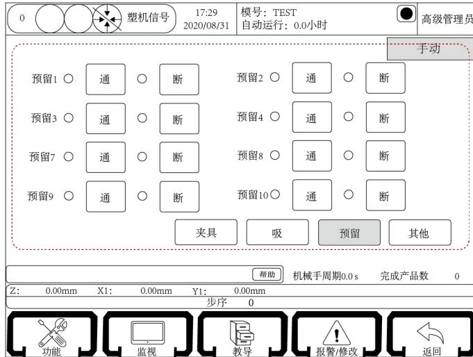
点击按钮“通”即相应的预留点信号输出，点击按钮“断”即相应的预留点信号断开输出。本系统有六组固定预留和两组可选预留（预留 9 与预留 10 可在预留设定中设置），用户可根据需要选择。
