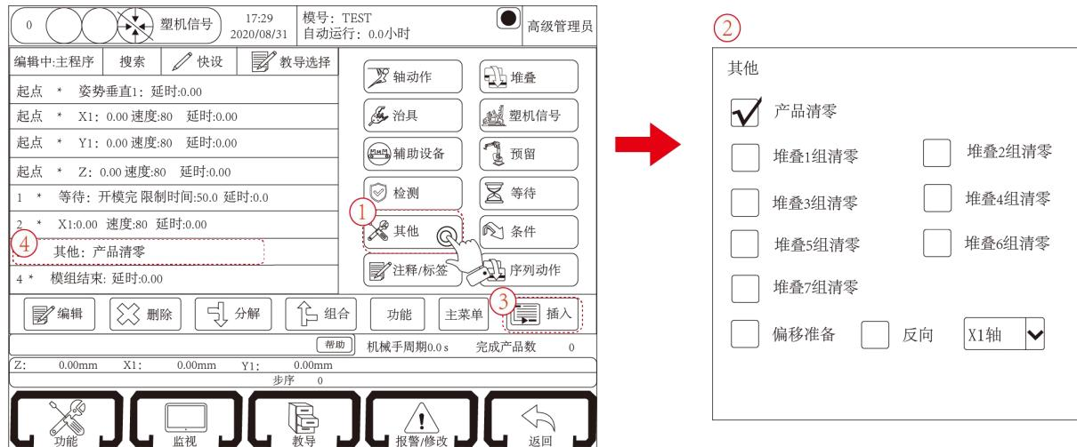
**产品清零：**此功能若插入到程序中，自动运行时，每执行到这一步，系统会将完成产品数置零，重新开始计数。
