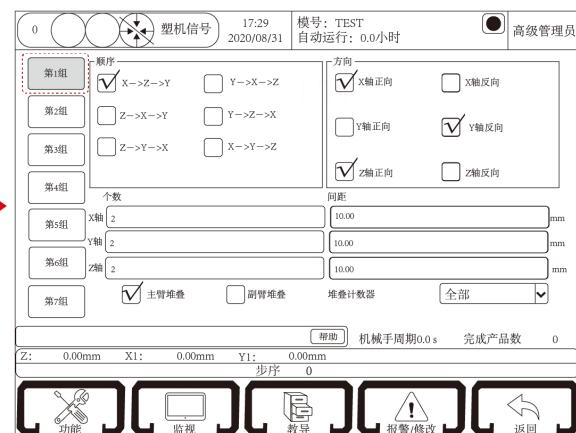
使用机械手的产品堆叠功能可以某种排列方式将成品整齐排列在输送带或装货箱上,本系统设置7组堆叠,前6组为规则堆叠,第七组为自由堆叠。
