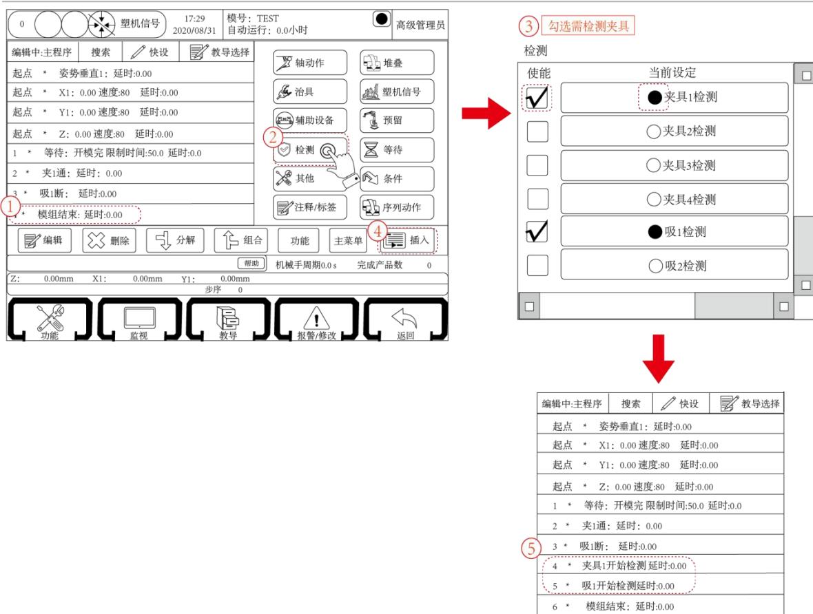
控制器可控制四组夹具和四组吸盘动作，治具和治具检测功能的教导同轴动作的教导，检测程序要教导到治具动作之后。
