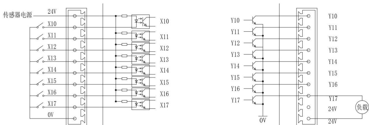
其它输入信号 X20~X27, X30~X37, X40~X47 接线方式同上图 X10~X17,
