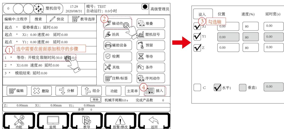
在该页面可以教导伺服轴的位置、速度和延时时间，选择气动轴的水平或垂直状态。
