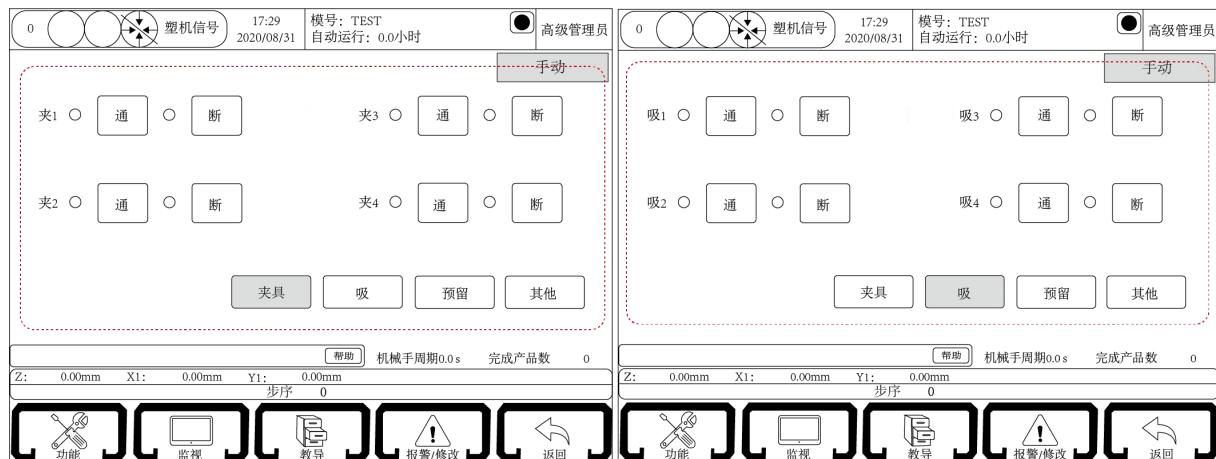
治具分为两种，“夹具”和“吸具”各四组，点击按钮“通”即相应的治具信号输出，点击按钮“断”即相应的治具信号断开。
