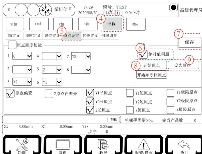
**注：**绝对值回原点，只能使用功能—机器参数—结构—原点设定的“开始原点”与“设为原点”按钮，而不能使用面板上的“原点”键与“启动”键回。
