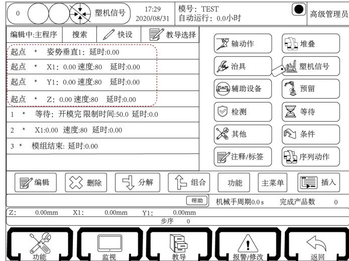
起点显示和轴定义“机器参数和安全点设定”选择相对应，即选择几个轴对应的起点就有几个轴，若起点和轴定义中轴个数或种类不同，则会报警“待机点位置错误”，此时需新建模号或者将轴定义选择正确。
