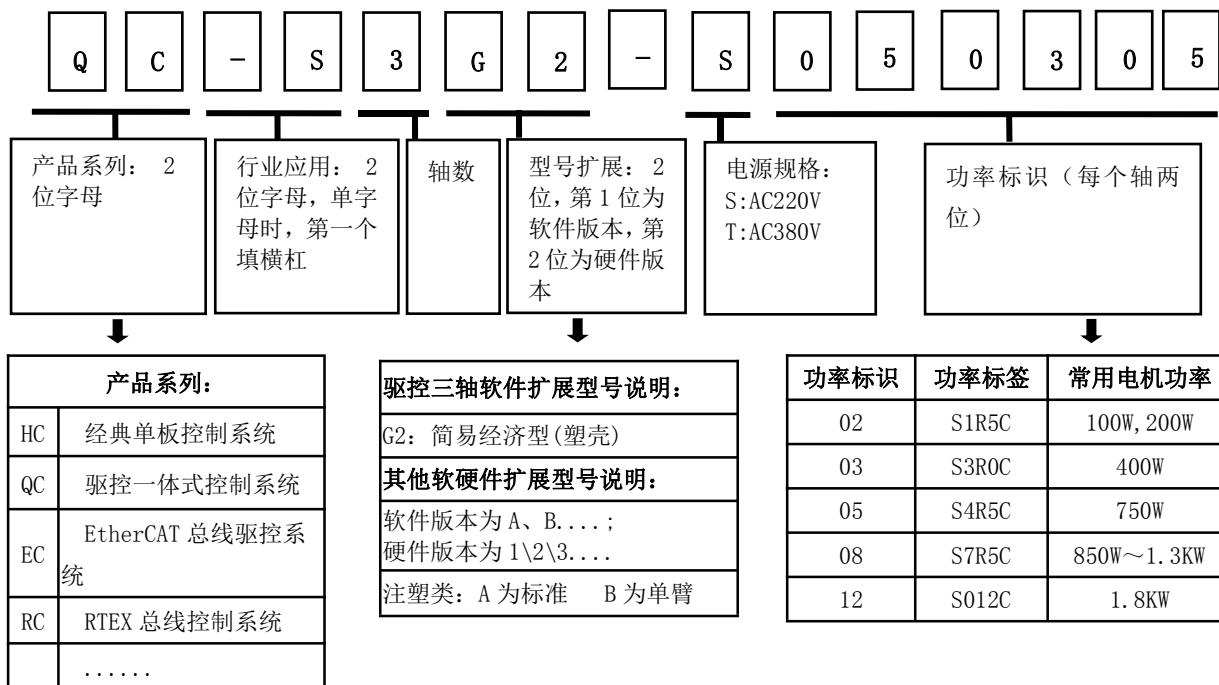
例: QC-S3G2-S050305: 表示三轴驱控一体塑壳经济型注塑机机械手控制系统;
