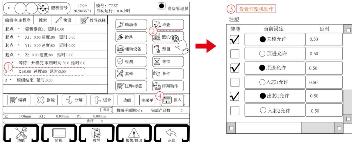
指示灯绿色为通，灰色为断。教导某动作通，该信号开始输出，教导某动作断，该信号断开输出。“顶进允许”和“顶退允许”不会占用循环时间。
