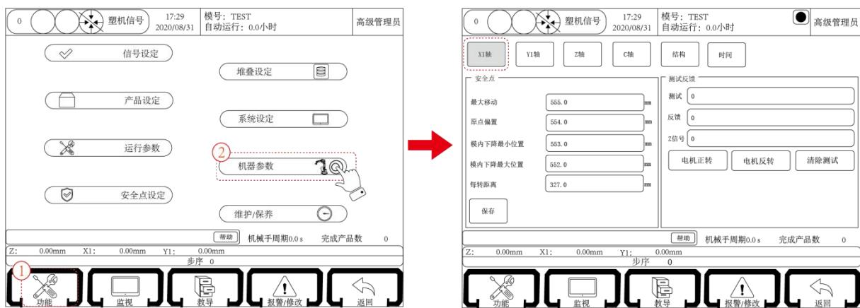
**电机正反转测试判断方案：**点击“电机正转”，电机将会向正方向旋转一圈，同时，当前页面中的反馈为 10000；点击“电机反转”，电机将会向反方向旋转一圈，同时，当前页面中的反馈为 -10000。
