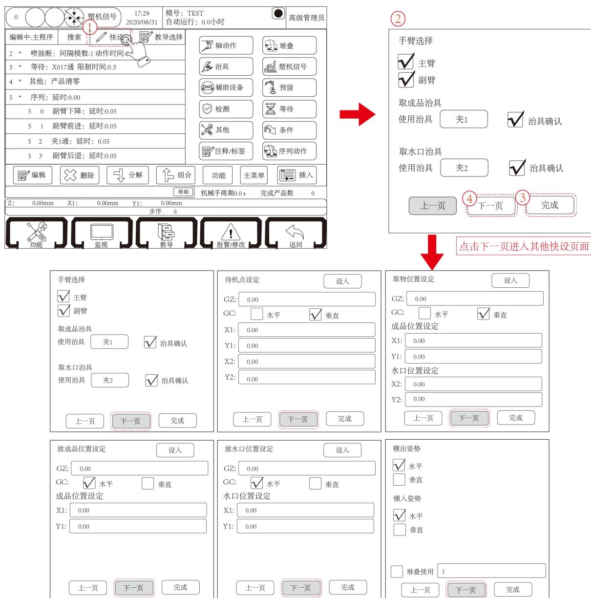
如上图所示，程序快速设定，可以只设定位置和选择动作。程序即可自动生成可执行的程序，
