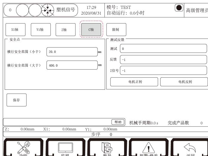
**最大旋转:** C 轴旋转的最大范围为 360 度
