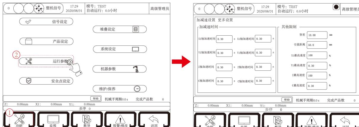
**容差：**指令运行的距离与实际运行反馈回的距离之间的差值。**(此参数不影响系统定位精度)**
