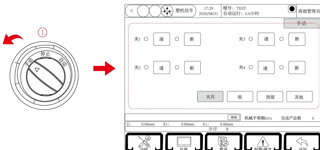
旋转状态旋钮后，进入手动画面，可进行手动操作，操作机械手各自单一动作，及调整各部分机械（手动操作时确认有开模完信号再进行操作，并确保不得碰触模具）。为确保机械手及注塑机模具安全有下列几项限制情形：
