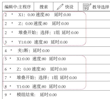
通过功能键上下移动、分解组合等按键，最终可将堆叠程序设置为左图的两种堆叠程序：
