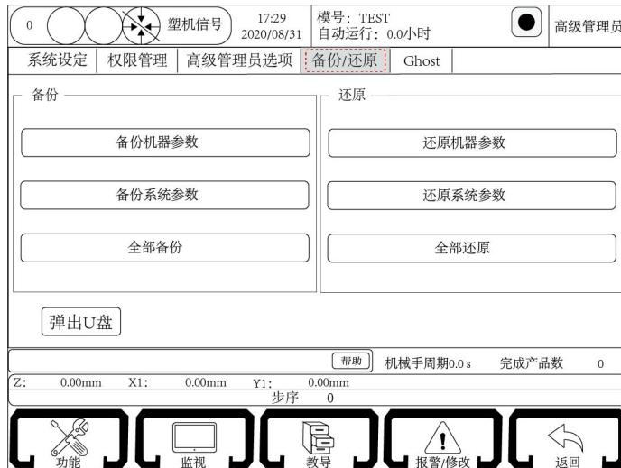
在该页面下可以使用 U 盘对“机器参数”、“系统参数”、“全部参数”分别进行备份和还原。参数还原后, 手控器会自动重启。
