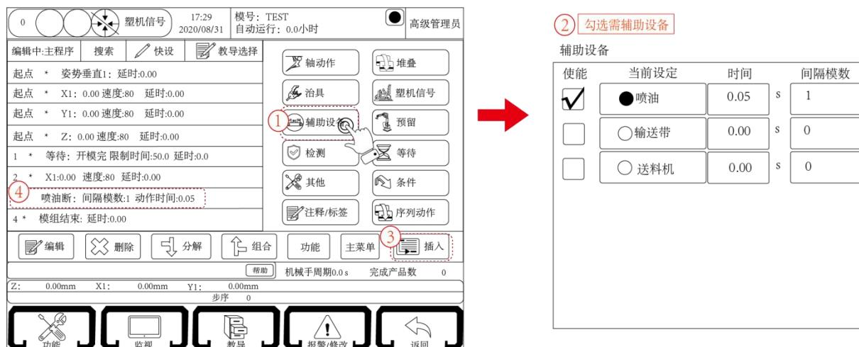
时间：设定该辅助设备的执行时间，辅助设备全为时间控制，只需教导通动作，到达设置的执行时间后，会自动断开输出（此时时间不会占用循环时间）。
