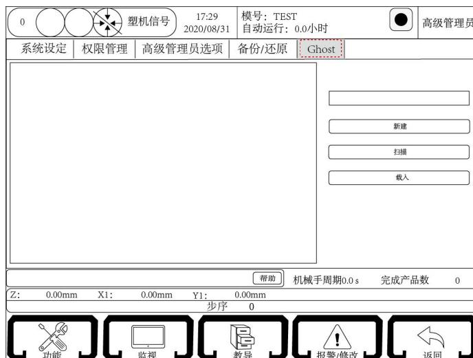
**新建:** 在红色框内输入名称, 点击新建按钮, 系统会将手控器上所有参数, 包括手控程序备份到 U 盘 (需事先插入 U 盘)
