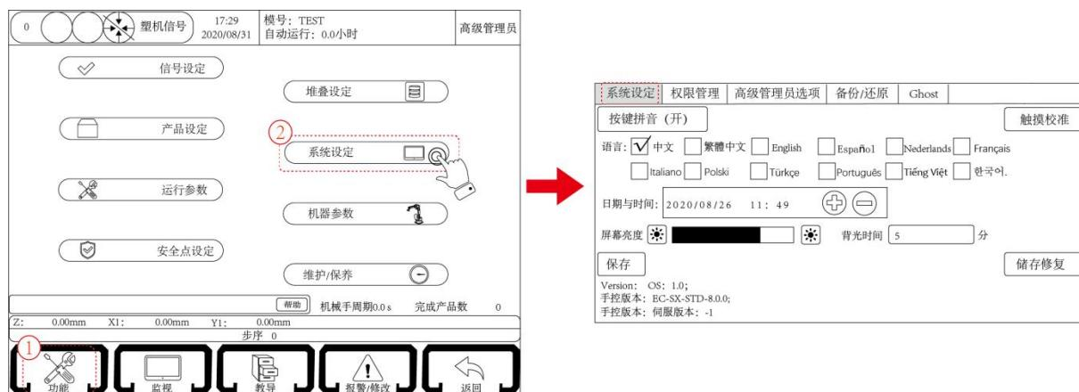
**小提示:** 若在档案里面出现不能新建, 复制, 删除程序。请点击“存储修复”功能。系统会自动重启修复存储。
