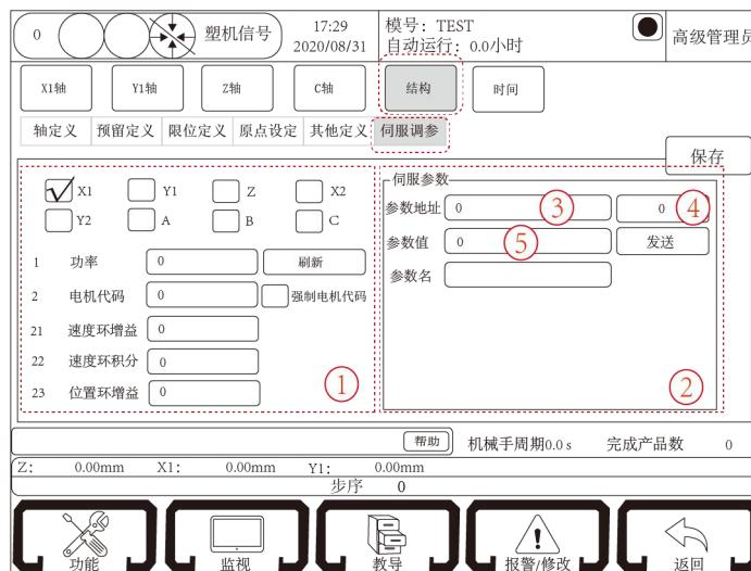
框 1 内为查看对应轴的伺服参数，点击刷新按钮，对应框内会显示伺服参数值，若需修改参数值，可直接在文本框内输入新的值，也可通过右边框 2 内设置伺服参数
